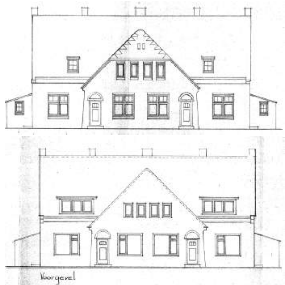
Aanzicht voorgevel bestaande toestand (boven) en nieuwe toestand (onder) van woning type N op de tekening van 1964. Archief opdrachtgever.
