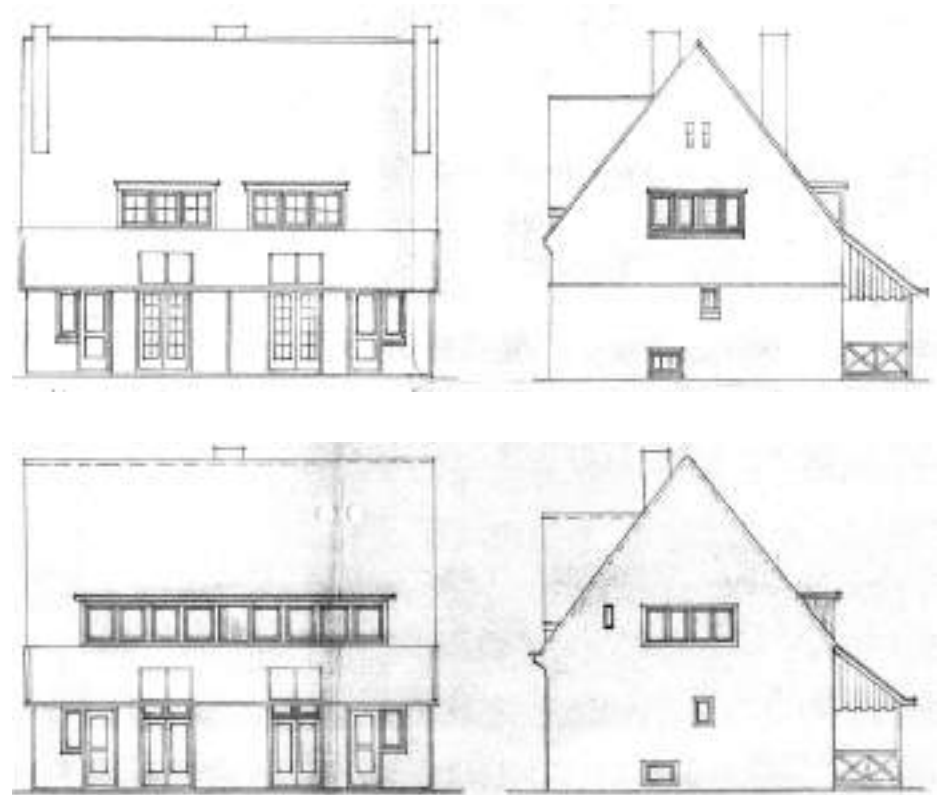
Achter- en zijgevel bestaande (boven) en nieuwe toestand van woning type H op de tekening van 1964. Archief opdrachtgever.
